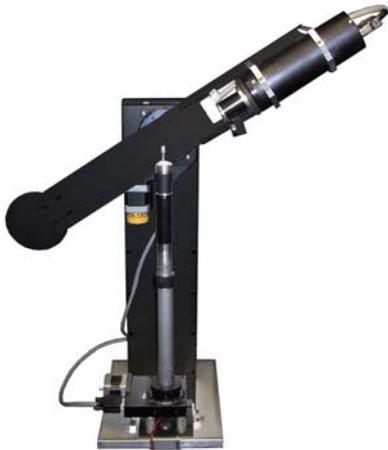
Bild 5: Nahfeld-Goniophotometer RiGO801 für LED's und kleine Lampen
