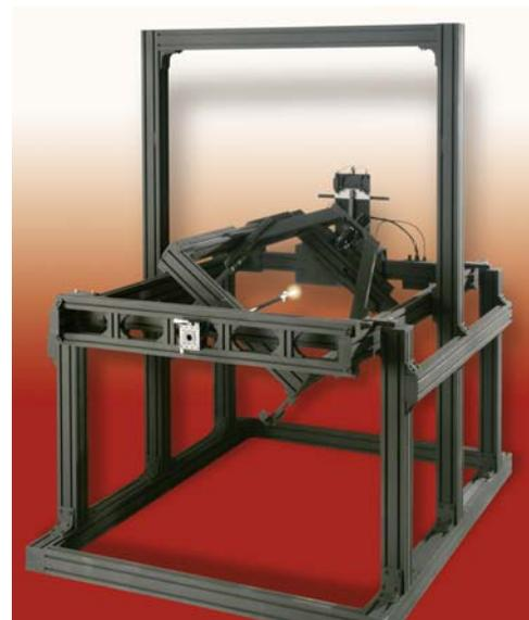
Bild 7: Nahfeld-Goniophotometer RiGO801 für Lampen und kleine Leuchten, mit eigenem Rahmen (dieser eingehängt in zusätzliches Gestell) für die Einstellung unterschiedlicher Brennlagern der Messobjekte
