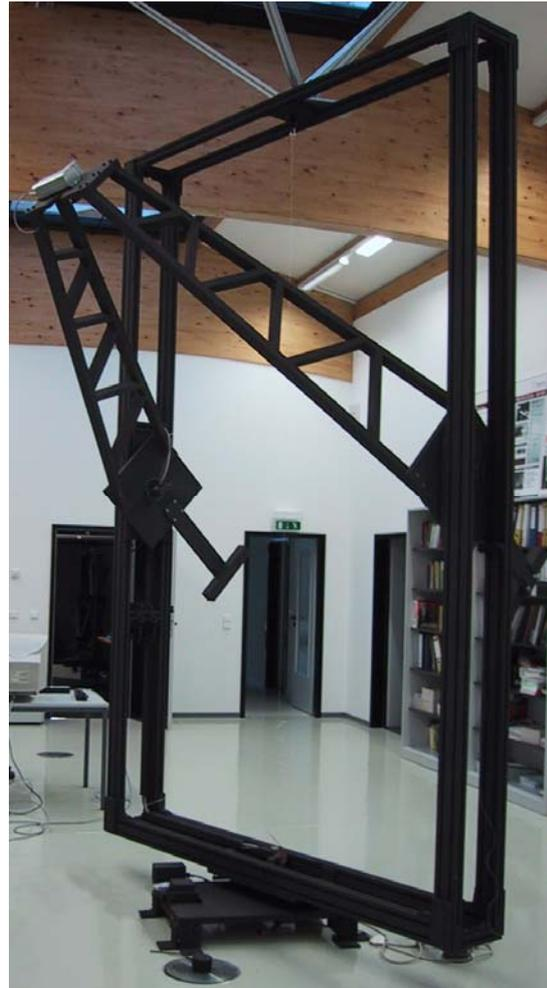
Bild 8: Nahfeld-Goniophotometer RiGO801 für Leuchten bis 2000 mm Abmessungen
