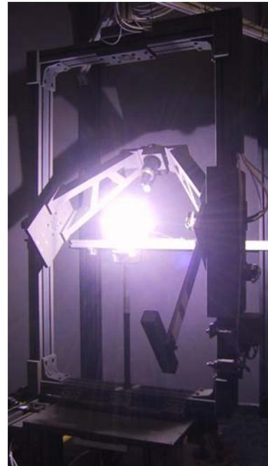
Bild 6: Nahfeld-Goniophotometer RiGO801 für Lampen und kleine Leuchten
