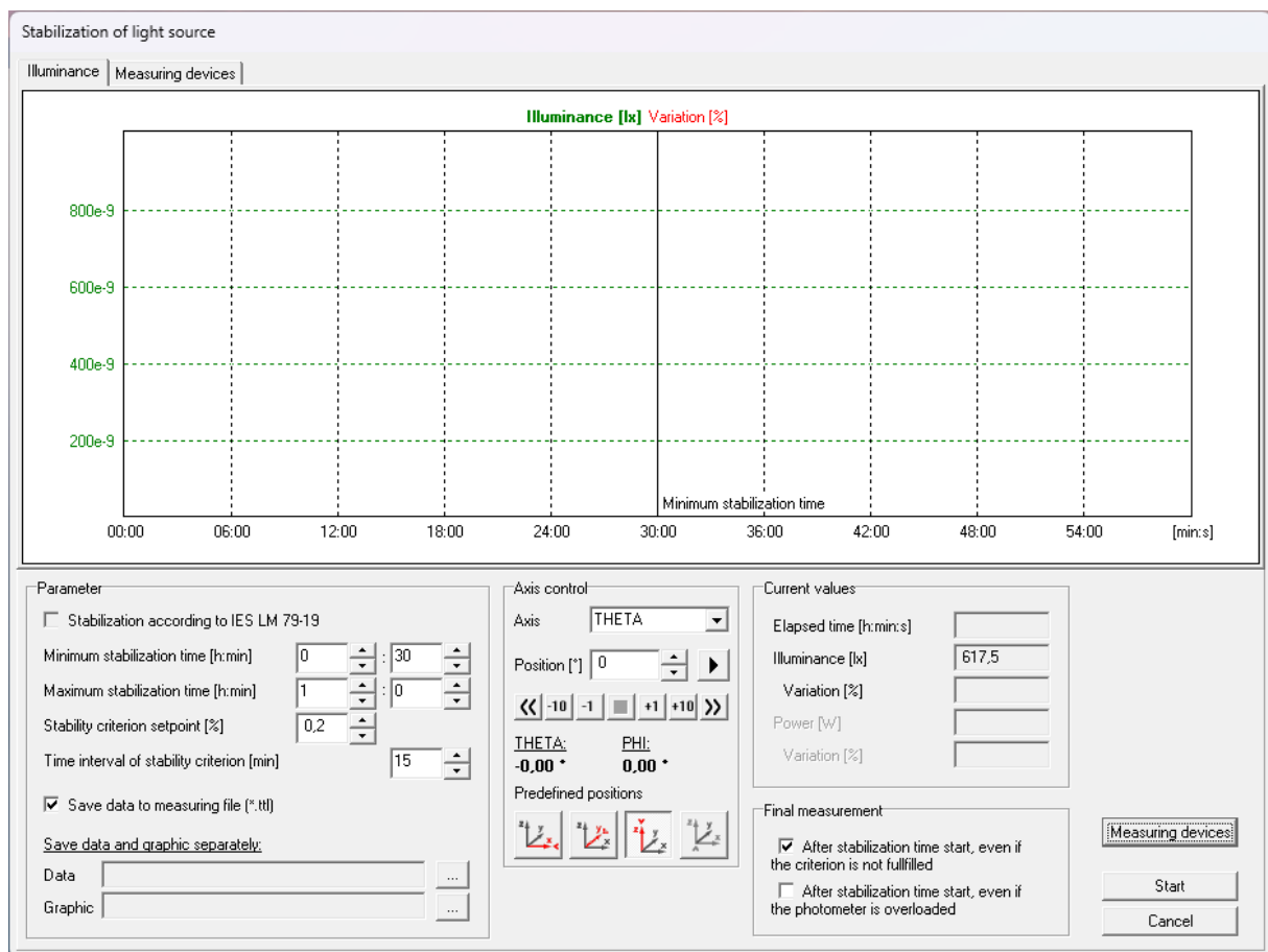
Abbildung 15: Automatischer Start der Messung nach Stabilisierungsphase
