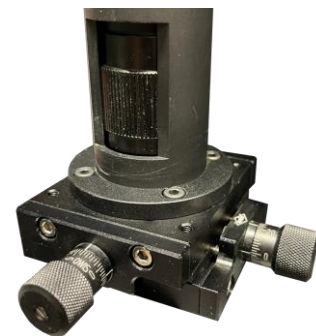
Abbildung 8: X/Y Stelleinheit und Z-Feinversteller
