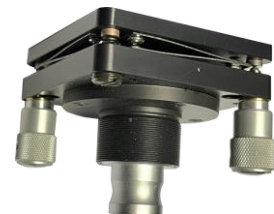
Abbildung 9: Nivelliereinheit der Messfassung
