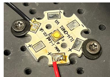
Abbildung 5: Montierte LED Platine
